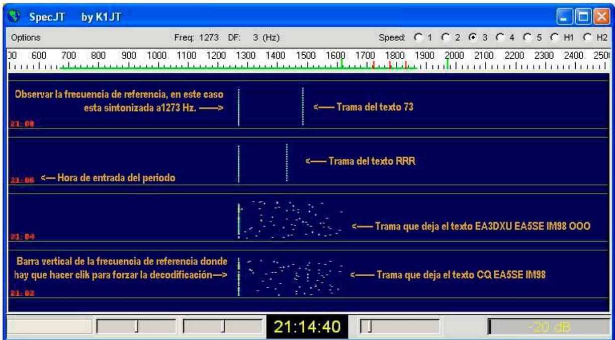
**Figura 3. Se aprecia la señal de entrada al RX en los distintos periodos del QSO.**
