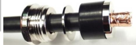
Kupfergeflecht im rechten Winkel hochbiegen. Kontakthülse zwischen Kupferfolie und Geflecht bis zum Anschlag einschieben. Überstehendes Geflecht abschneiden. Gummidichtung bis zur Kontakthülse nach vorne schieben.
