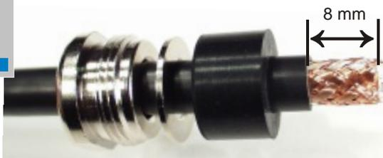
Mit einem Messer 8 mm des PVC-Mantels entfernen.
