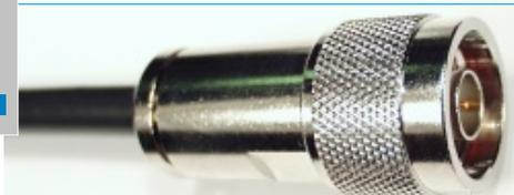
Das so vorbereitete Kabelende bis zum Anschlag in das Steckergehäuse einschieben. Mit zwei Maulschlüsseln 16 mm die Spannmutter handfest anziehen. Ein kleiner Spalt zwischen Mutter und Steckergehäuse sollte noch sichtbar sein!
