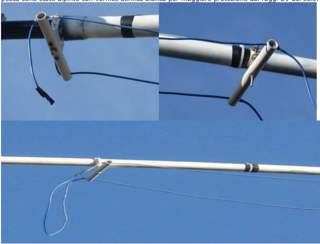
Ecco il particolare dell'assemblaggio Bal-Un – choke – dipolo:
