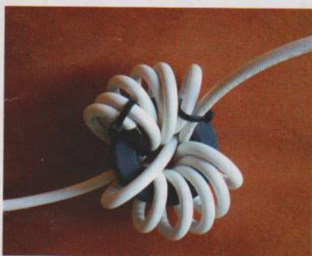
Imagen 7. Choque de RF para 40 metros sobre toroide FT240 con 12 espiras de RG-6
