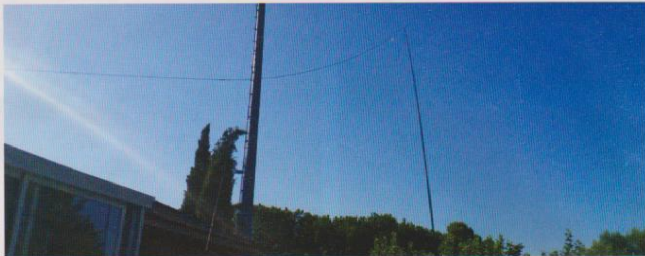
Imagen 8. La antena montada sobre una caña de fibra de vidrio en forma de L invertida.
