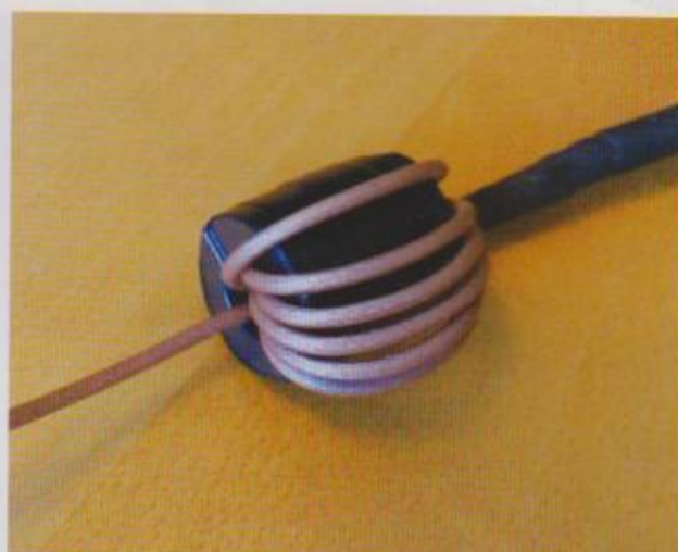
Imagen 6. Choque de RF para 20 metros con cable coaxial RG-179
