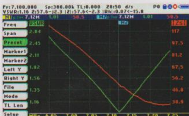
Imagen 9. Curva de ROE en la banda de 40 metros medida con el analizador vectorial SARK-110
