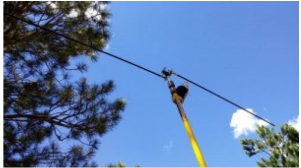
Dipolo NVIS de 40 metros desplegado utilizando martillos cargados en lugar de alambre.
