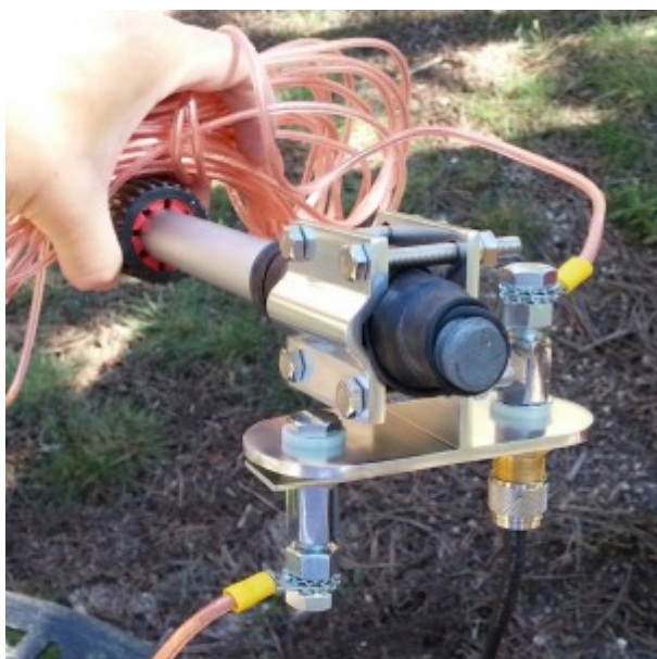
Ambos elementos de cable radiante y cable coaxial están conectados, listos para el despliegue.
