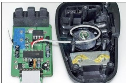
En las instrucciones se incluyen algunos ejemplos de cómo configurar la matriz de puentes del cable de micrófono. Para todos los demás casos, verifique la asignación del pin en el manual de su transceptor. Si solo desea usarlo con un transceptor, probablemente sea mejor para la estabilidad de contacto a largo plazo soldar directamente los cables de puente a la PCB en lugar de usar los receptáculos (aunque no he visto ningún problema con los cables de puente durante los 3 años Lo
