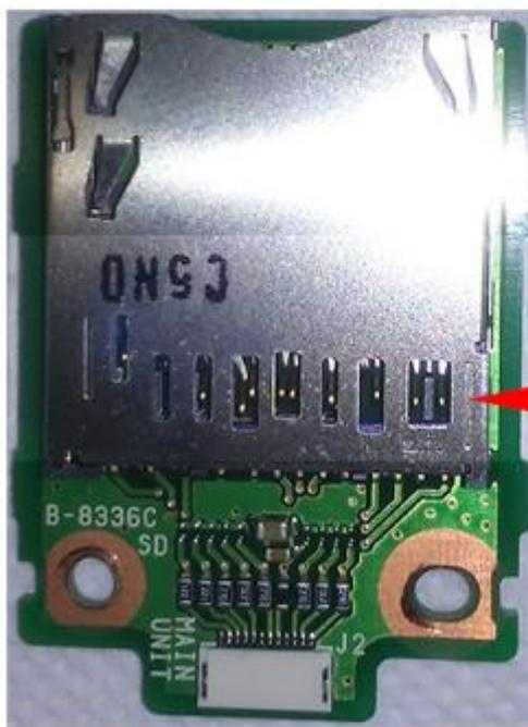
· Retirar la "platina/encapsulado de aluminio C5N0" que sujeta la "tarjeta SD".
