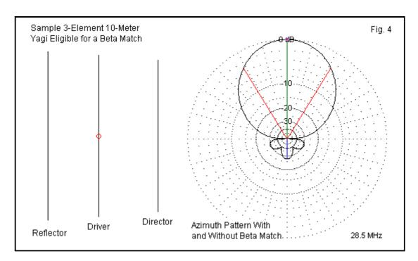
Yagi de 10 metros y 3 elementos Dimensiones en pulgadas Frecuencia de diseño: 28,5 MHz Elementos: elemento de aluminio de 0,5" Longitud Separación desde el reflector Reflector 206,28 ----[Controlador (resonante) 196,97 62,40] Controlador (acortado) 192,20 62,40 Director 185,33 134,54
