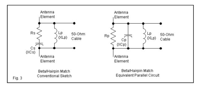
Tenga en cuenta que la red L consta de resistencias de fuente y carga, con una combinación de reactancias en serie y en paralelo. Suponga que convertimos los componentes de impedancia de la antena en serie en sus valores paralelos equivalentes. Como referencia, aquí están las ecuaciones de serie a paralelo. Tenga en cuenta las similitudes que le permiten simplificar las pulsaciones de teclas reales necesarias en una calculadora manual.
