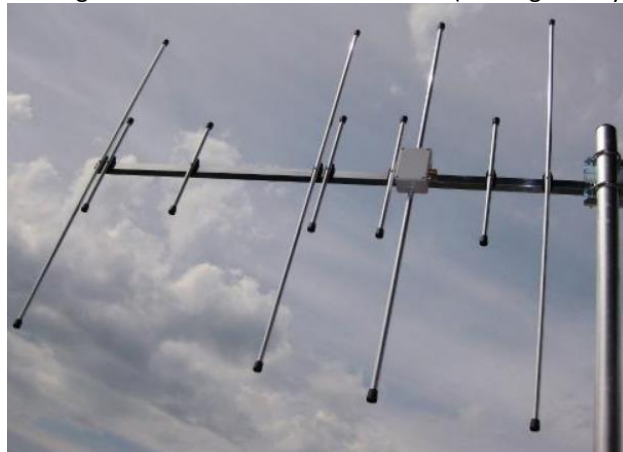
El 4/5-El.-Yagi con elementos de 8 y 10 mm (rediseñado por SQ9VPA) (The 4/5-El.-Yagi with 8 and 10-mm-Elements (redesigned by SQ9VPA))
