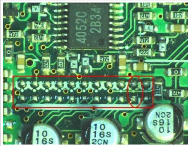
Este es el banco de almohadillas de soldadura que se utiliza en la fábrica para instalar puentes de configuración. La posición indicada con una elipse es desde donde quité el puente de rango de transmisión, visto después de que se quitó.
