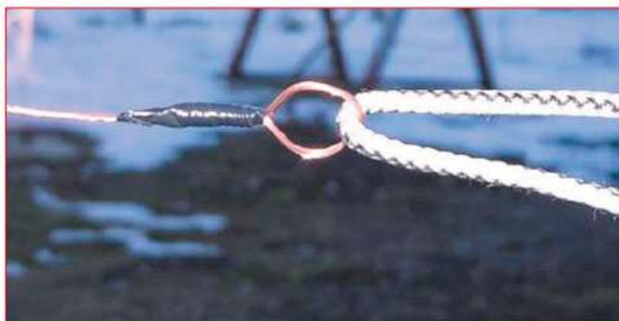
Empalme del cable 0.50 mm con los globos.
