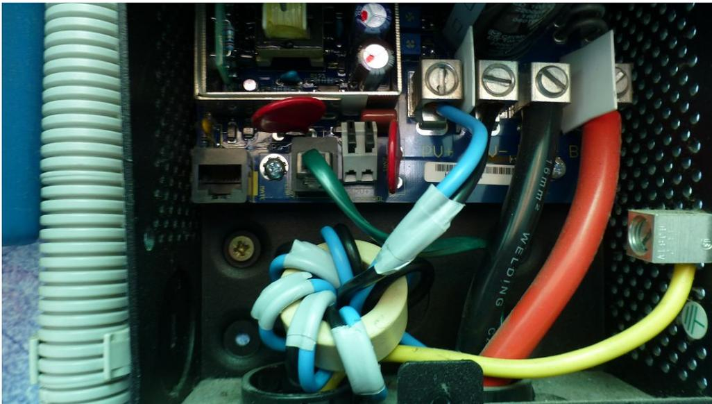
Se aprecia el transformador de corriente 1:1 a modo de choque, justo a la entrada del regulador.
