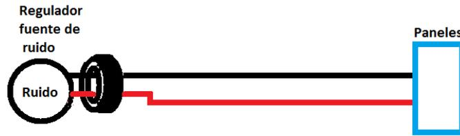
Otra opción es ver el regulador como si de un transmisor se tratase y fijar nosotros una impedancia baja para que no nos afecte a los cálculos la que pudiera presentar el cable y los paneles. De forma arbitraria he asignado 5 Ohms. Me parece lo suficientemente baja para mantener las bobinas pequeñas, por tema de capacidad de corriente y frecuencia de autoresonancia de las mismas.
