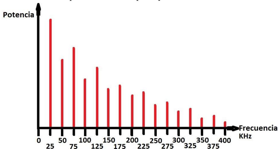
Esta gráfica representa en el eje horizontal, la frecuencia. En el inicio está el cero, y a medida que nos desplazamos a la derecha, la frecuencia aumenta. En el eje vertical se representa el nivel de potencia. En el inicio no hay potencia, y a medida que subimos, la potencia es mayor. Sería un ejemplo parecido a lo que sería el contenido espectral de una señal con forma de onda, cuadrada.
