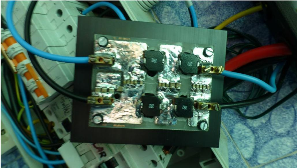
Las bobinas son inductores de la casa Bourns de color negro, y los condensadores son SMD . La resistencia terminal no se aprecia por que está bajo la placa, anclada al radiador.
