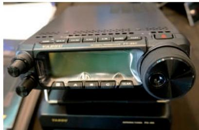
El Yaesu FT 891, HF – 100W, un magnífico equipo móvil compacto, con carátula separable y con un display muy legible. Otro acierto de Yaesu en el campo de los equipos para el coche o para portable
