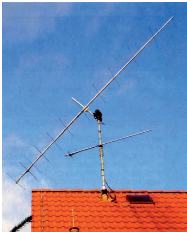
Figura 5. La Yagi de 12 elementos utilizada por DL1VPL para completar el DXCC en 144. [Foto de Thomas Hartig, DL1VPL].
