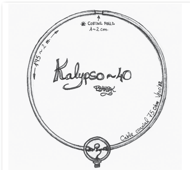
Lámina 1. Construcción de la Kalypso para 40 m
