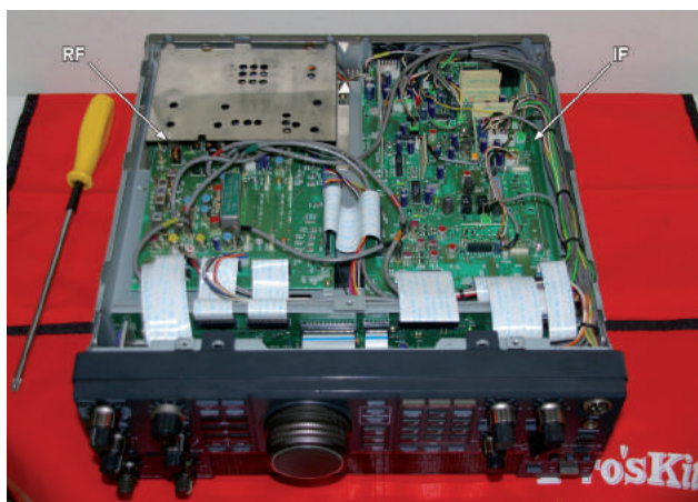
Imagen 9. Ubicación de la placa IF_UNIT
