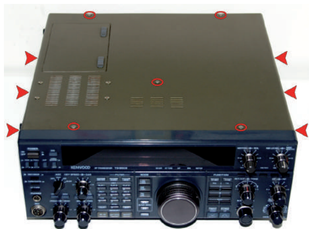
Imagen 2. Apertura de la tapa superior
