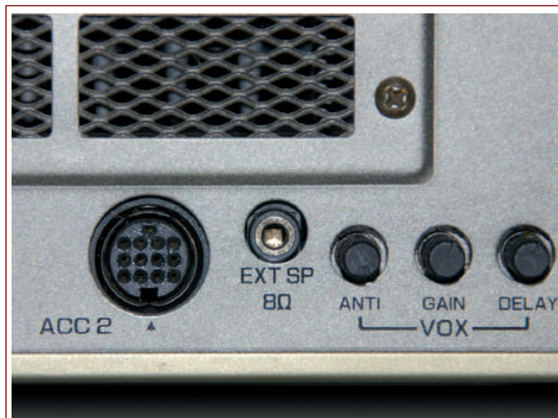
Imagen 10. Conector Jack para altavoz externo
