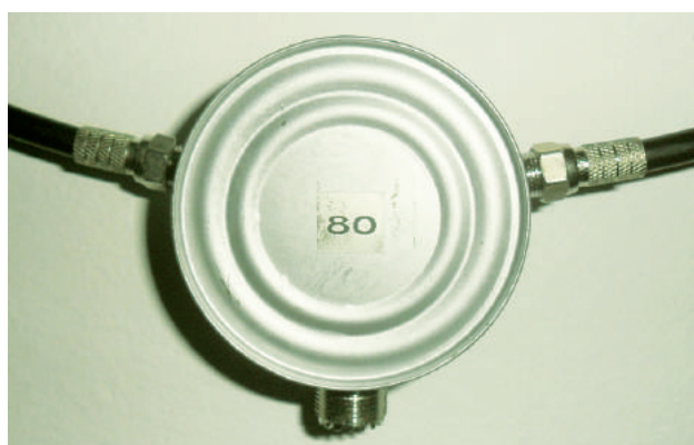
Foto 2. Construcción desmontable con conectores F y PL estilo «Tuna Thin»
