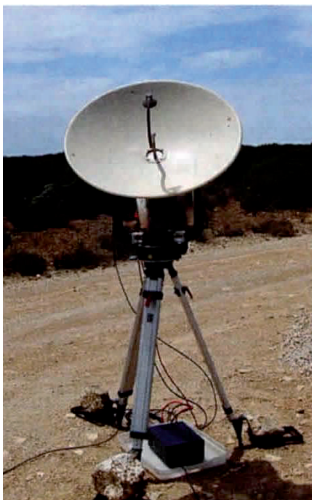
Figura 6. La parábola de la estación portable de 10 GHz de VK7MO al lado de una carretera en el desierto australiano [Foto de Rex Moncur, VK7MO].
