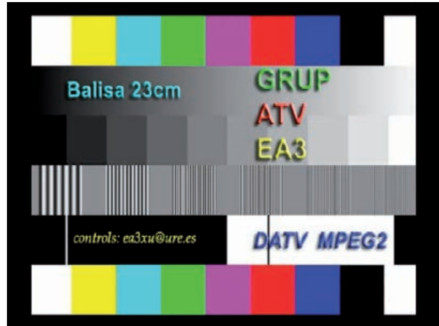
Fig. 7. Perfecta Recepción de la baliza DATV a 20 km -60 dBm
