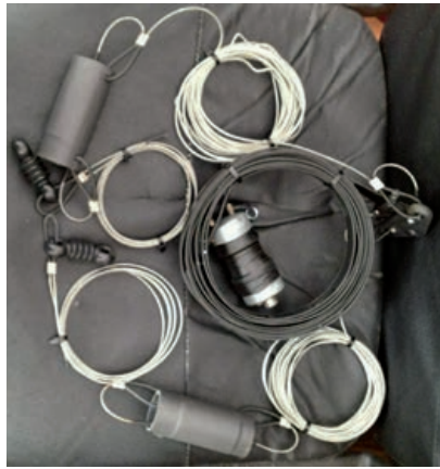
4. Dipolo con trampas Western HF-10, de fabricación inglesa. Otra variante menos ruidosa de la G5RV
