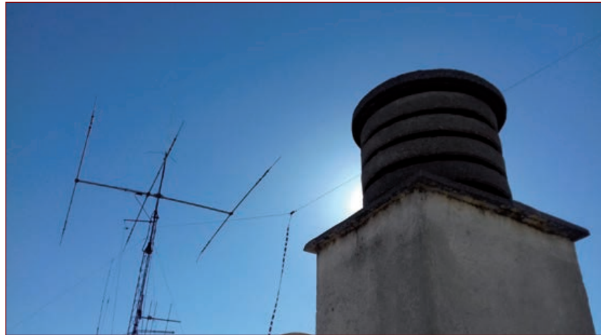
5. Aspecto del dipolo Western HF-10 de EA7HAE, con la bajada en escalerilla de 450 ohmios
