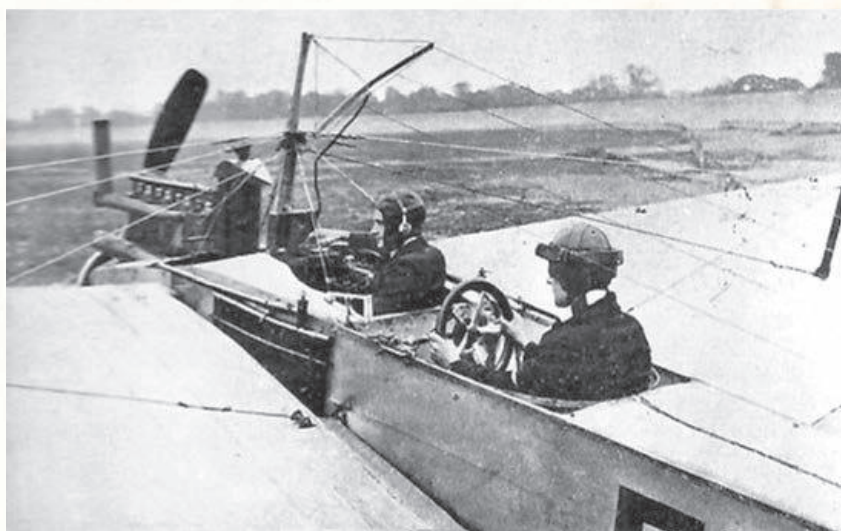
Septiembre de 1911. Ensayos de comunicación por radio aire-tierra realizado en Brooklands (Inglaterra), en un monoplano biplaza Flanders F.3 pilotado por E. V. B. Fisher, utilizando un transmisor radiotelegráfico portable de chispa Marconi alimentado con una batería de 6 voltios.
