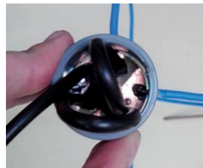
Imagen 30. Montaje adaptador PVC, Q-section, loops y placa PCB
