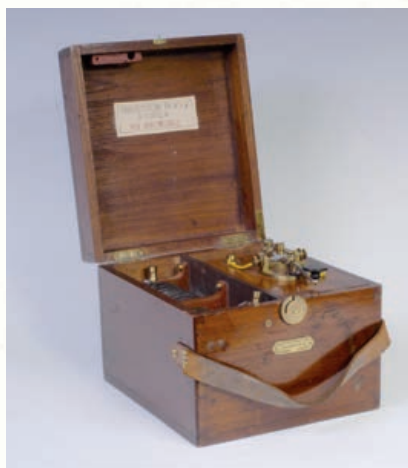
Transmisor radiotelegráfico de chispa para avión Marconi fabricado en 1912. 40 W
