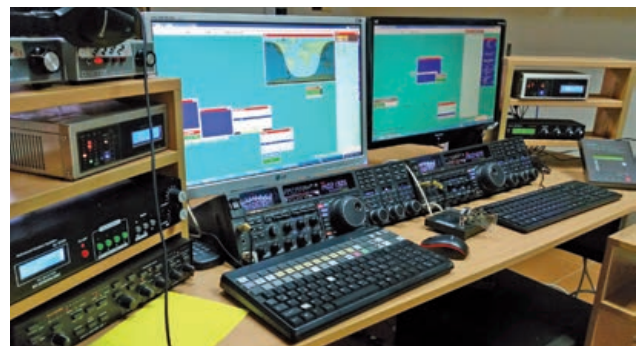
Detalle de equipos para SO2R en 403A. Estos puestos serán actualizados con equipos Flex Radio para los próximos concursos CQWW
