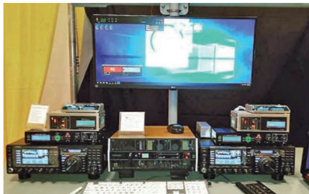
Instalación SO2R con radios convencionales conectadas a través de LAN con el Interface Genius. En el medio está el primer prototipo del amplificador Power Genius XL que se mostró en Dayton en mayo de 2016
