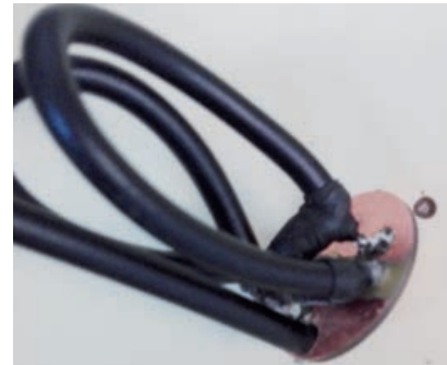
Imagen 29. Pieza PCB tallada con cable alimentación y Q-section soldados
