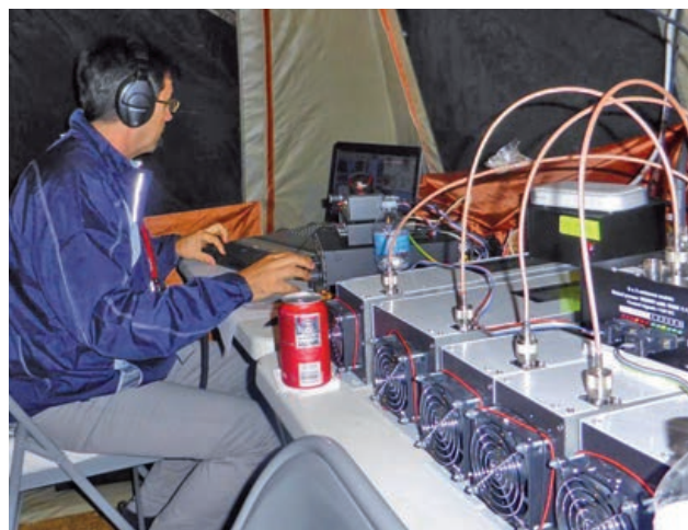
Ranko 403A operando como W1M en el WRTC-2014 de Boston. Se puede ver el triplexor y los filtros conectados una matriz conmutadora de antenas 6x2. Foto de HA1AG
