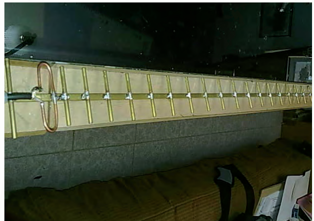
Figura 10. Antena Yagi de 2,4 GHz construida por EA4RN
