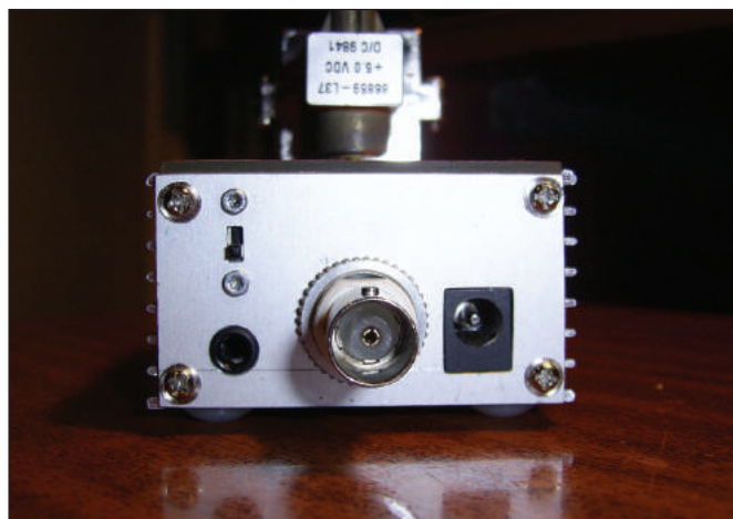
Figura 7: Vista posterior de uno de los transceptores. Se puede observar la conexión de microfono (izquierda) la salida de frecuencia intermedia (centro) y la entrada de alimentación (derecha). El pequeño interruptor deslizante activa el oscilador de doble tono.
