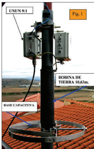
Figura 1: Se observa el soporte con dos UNUN con los que se han realizado diferentes pruebas con su conexión al hilo radiante y a la bobina de tierra con una base capacitiva.
