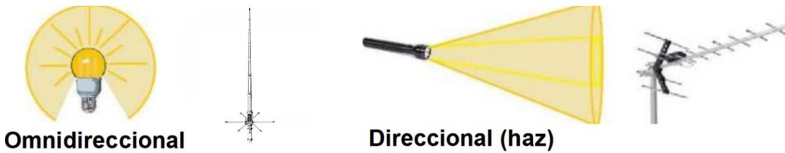
Figura 2: Analogía entre la propagación de la luz y las ondas de radio según su forma de emisión.
