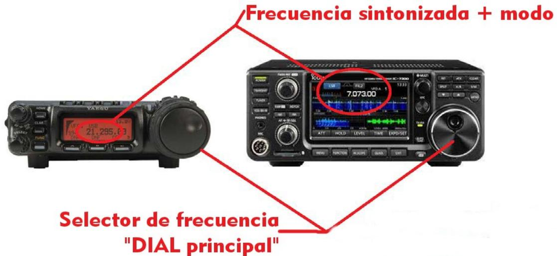
Para 'sintonizar' una frecuencia, debes seleccionar la misma que la estación receptora o elegir una frecuencia vacía para iniciar una conversación. Esto generalmente se hace con el dial principal grande (mando giratorio grande).
