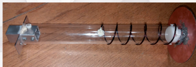
Figura 11. Antena autoconstruida para la recepción HamTV de la ISS. Inspirada en la web de G3RUH
