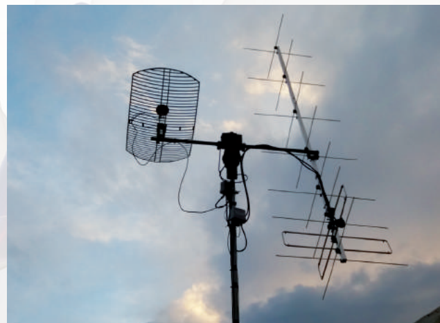
Figura 8. Antenas del sistema de seguimiento. Izquierda para la recepción de HamTV. Derecha Yagui 2 x 8 elementos de VHF
